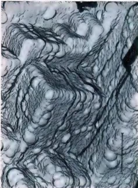
Bild 21. Elektronenbild einer geätzten Aluminiumoberfläche (—|— = 1/1000 mm)
